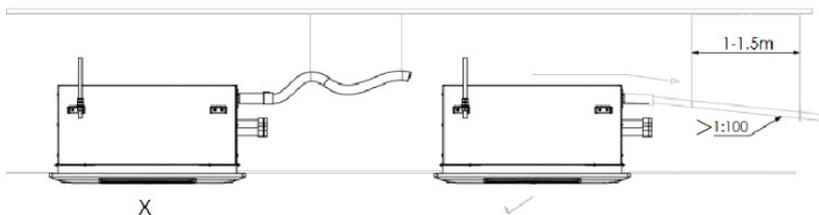
۲. حداکثر هد پمپ تخلیه دستگاه ۱/۲ متر می باشد، لذا جهت پیشگیری از مشکلات احتمالی برگشت آب تقطیر به دستگاه (بعد از خاموش شدن فن کویل) لوله تخلیه آب میبایست مطابق شکل زیر اجرا گردد.
