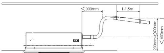
۳. زمانیکه تعدادی دستگاهی را به یک لوله تخلیه آب مشترک متصل میکنید، لوله مشترک میبایست حداقل ۱۰ سانتیمتر از محل تخلیه تمامی دستگاه ها پایین تر باشد
