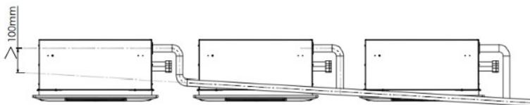
۴. جهت جلوگیری از تشکیل شبنم بر روی لوله تخلیه درین پیشنهاد میگردد این لوله عایق گردد.
